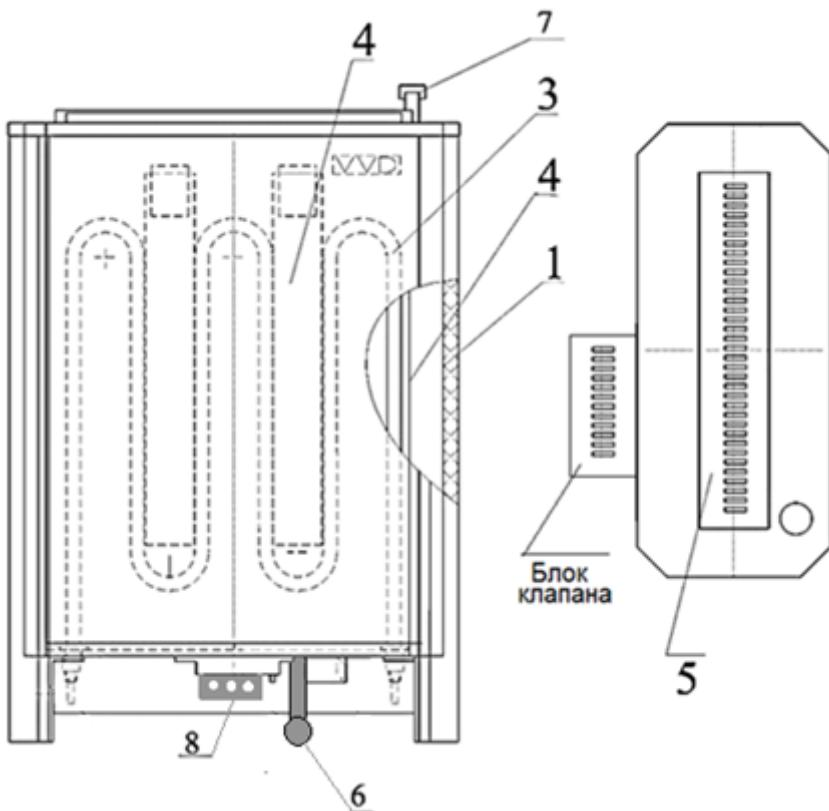
Рис.2 Устройство Автономного ЭГПП 3,9-6,0 кВт
